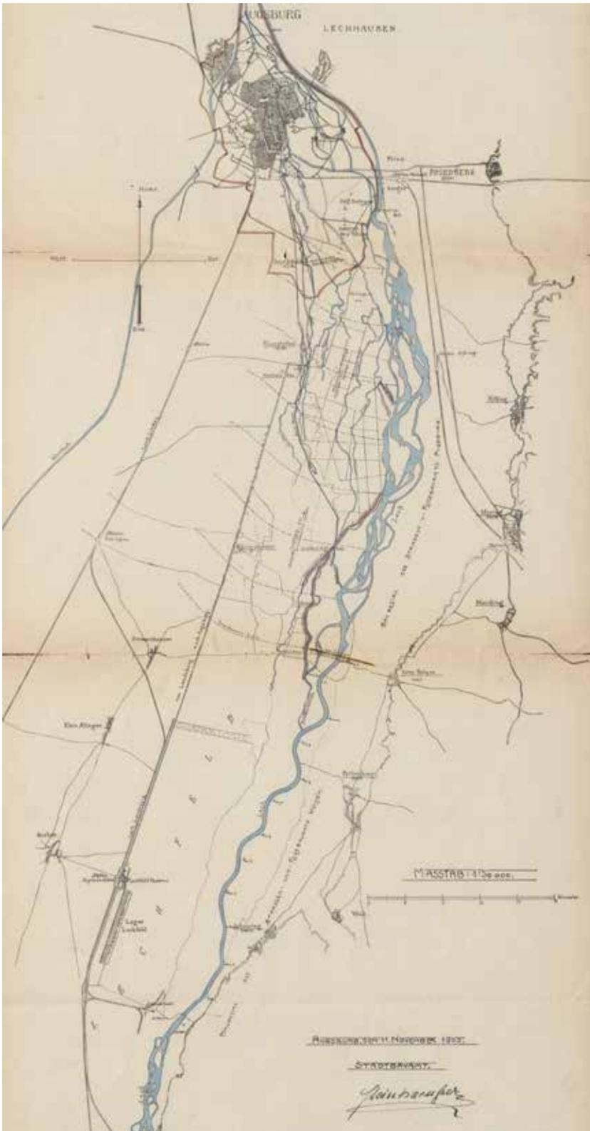
**Abb. 3:** Der Lech südlich von Augsburg mit Korrektionsgrenze in Höhe von Unterbergen, 1903. Zwischen Unterbergen und dem Zollhaus bei Lagerlechfeld ist die bereits 1903 regulierte Fließstrecke zu erkennen. (Stadtarchiv Augsburg: Hauptaktenverwaltung – Bauwesen, Signatur 20907/735).
