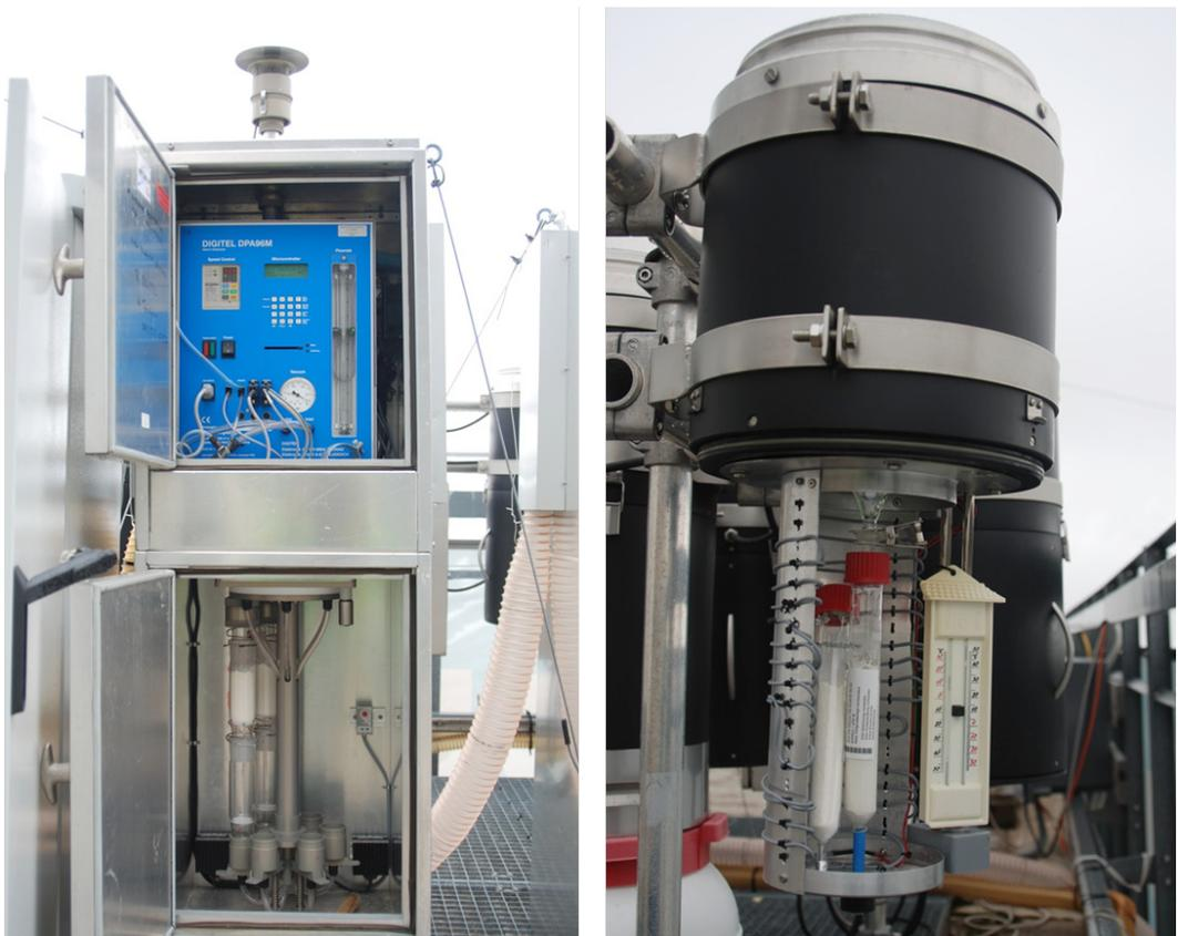
**Abb. 3:** Links: Steuerungsaggregat (oben) und Kartuschenwechsler (unten) zur aktiven Luft-Probenahme. Rechts: Beheizbarer Sammeltrichter (oben) und Adsorber-Kartuschen (unten) für die Beprobung der Deposition. (Fotos: K. Freier, LfU).
