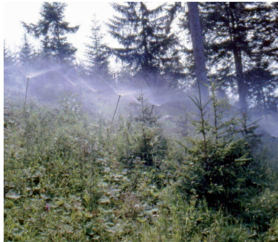
Abb. 6: Transportable Beregnungsanlage zur Simulation von Starkregenereignissen, hier am Jenner/Berchtesgadener Alpen. (Foto: G. Bunza, 1987).
