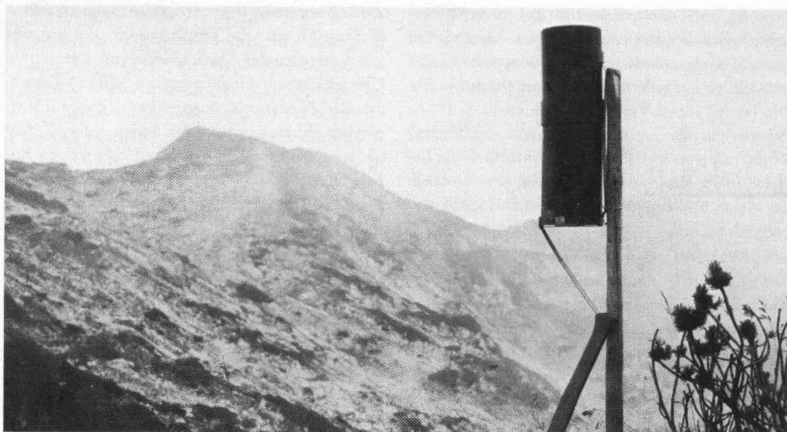
Zur Messung der Niederschläge wurden im Gebiet für einige Monate an fünf Stationen vom Inntal bis zum 1910 m hohen Zwölferkogel (siehe Aufnahme) Ombrometer aufgestellt. Die Ergebnisse zeigen dabei deutlich Regenstau und Regenschatten in Abhängigkeit vom Relief sowie Zunahme des Niederschlages mit der Höhe abgesehen vom „Gipfelfeffekt“ am Zwölferkogel. Im Hintergrund die Pyramidenspitze. 15. 8. 1977
