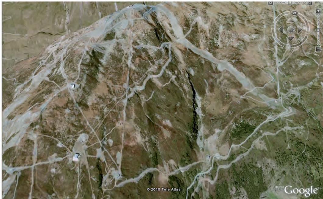
Abb. 12b: Satellitenaufnahme des Skigebiets von La Rossière bei Bour St. Maurice/Savoyen/Frankreich. Es ist eine hohe Dichte an stark erosiven Pisten, Straßen, Liftspuren und Liftstationen in Höhen zwischen 2000 und 2200 m zu sehen. Beachtenswert ist die neu angelegte Skipiste an der oberen rechten Ecke der Aufnahme (Google Earth Image 2006).
