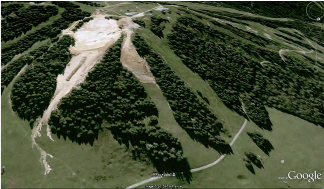
Abb. 17b: Während der Bauphase des Gipfelspeichers zur Kunstsneeproduktion auf dem Mont Lachat nahe Crest-Voland/Hochsavoyen/Frankreich in 1500 m Höhe kam es im Zusammenhang mit einem Starkregen zu einer Mure. Die Sedimente lagerten sich in typischen Loben auf den Almwiesen darunter ab. Die Spuren des Geschehens wurden anschließend weitgehend planiert. (Google Earth Image 2006).
