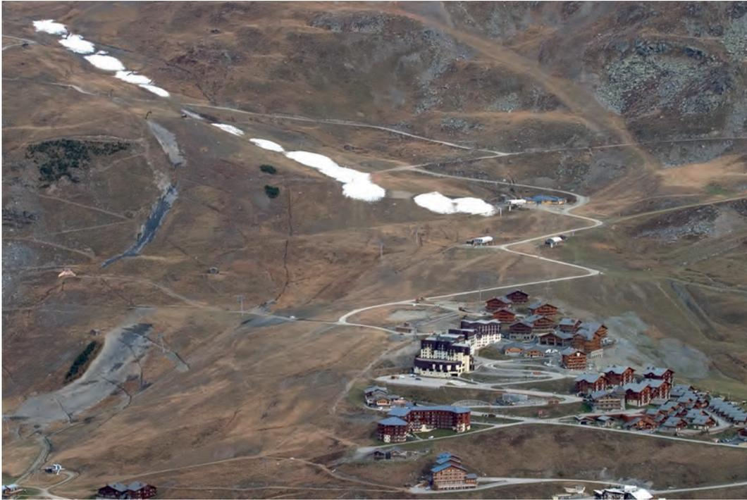
Abb. 17a: Mehrere tieferreichende Hangrutschungen in Höhen zwischen 1900 und 2100 m in Les Menuires/ Frankreich als Folge der durch den Pistenbau veränderten Topographie und Hangwasserverhältnisse für die steilen Slalom-pisten. Das gesamte Gebiet ist gekennzeichnet durch zahlreiche ältere Hangrutschungen. (Foto: Kees Wolthoorn 2007).
